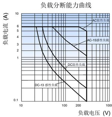
测试条件: 常温, 塑封型, 1s通9s断
