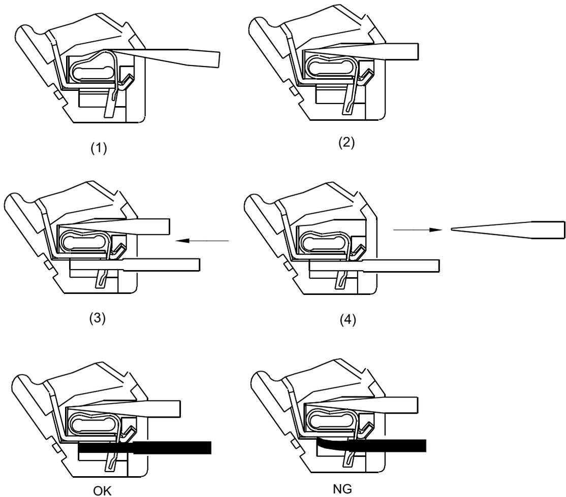
注：在使用绝缘保护直径为 $\phi 3\text{mm}$ 以下的导线时，请勿将导线的绝缘部分插入夹簧夹开口处。
